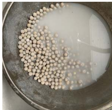
Figure 4 - Média neutralisant après rinçage à l'eau claire
