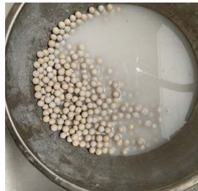
Figure 5 - Média neutralisant après rinçage à l'eau claire
