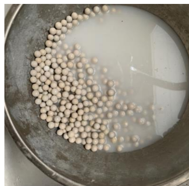
Figure 6 - Média neutralisant après rinçage à l'eau claire
