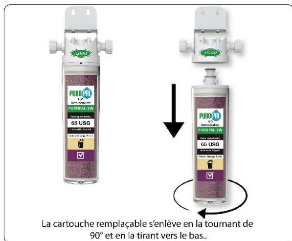
Figure 2 – Remplacement d'une cartouche
